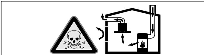
Kurišča, odvisna od zraka v prostoru (npr. grelne naprave na plin, olje, les ali premog, pretočni grelniki, boilerji) črpajo zrak za izgorevanje iz prostora, v katerem so nameščeni, in odvajajo izpušne pline prek sistema za odvajanje plinov (npr. dimnika) na prosto.
