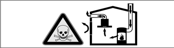
Huoneilmaa tarvitsevat tulisijat (esim. kaasu-, öljy-, puu- tai hiilikäyttöiset lämmityslaitteet, läpivirtauskuumennin, vedenkuumennin) ottavat polttoilman huoneilasta ja johtavat poistoilman poistoilmalaitteen (esim. savutorven) kautta ulos.
