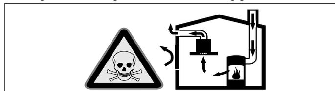
Ildsteder som er avhengig av romluft (f.eks. varmeapparater som drives med gass, olje eller kull, varmtvannsbereidere) bruker forbrenningsluften fra oppstillingsrommet og leder avgassene gjennom et avgassanlegg (f.eks. pipe) i det fri.
