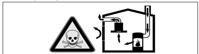
Grijala na plamen koja ovisе o zraku iz prostorije (npr. plinska grijala, grijala na ulje i drva ili ugljen, protočni grijači vode, uređaji za pripremu tople vode) troše zrak za sagorijevanje iz prostorije u kojoj je postavljen uređaj i odvode dimne plinove kroz dimovodne uređaje (npr. dimnjak) na otvoreno.
