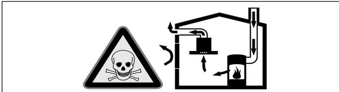
Топки із підведенням повітря із приміщення (напр., опалювальні установки, які працюють на газі, рідкому паливі, дровах чи вугіллі, проточні нагрівачі, бойлери) забирають повітря для горіння палива із приміщення, де вони установлені, а газ, що виділяється при цьому, відходить через витяжну систему (напр., димохід) на вулицю.
