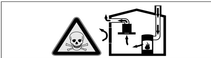
Vatrišta koja zavise od vazduha u prostoriji (npr. grejni uređaji na gas, ulje, drvo ili ugalj, protočni bojleri, kotlovi za zagrevanje vode) vazduh za sagorevanje crpe iz prostorije u koju su postavljeni i izduvne gasove izbacuju preko sistema za izduvne gasove (npr. kamoin) u spoljašnju sredinu.
