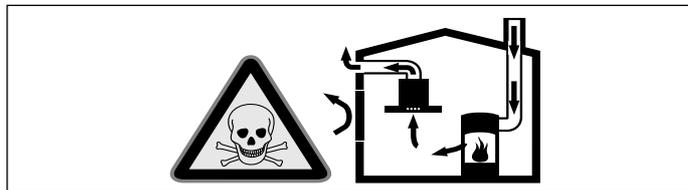
依賴室內空氣的製熱裝置（例如以氣體、汽油、木材或以煤炭為燃料的暖爐、循環加熱器或熱水器）係從其安裝處取得空氣加以燃燒，再經由排氣系統（例如煙囪）將廢氣排放至室外。
