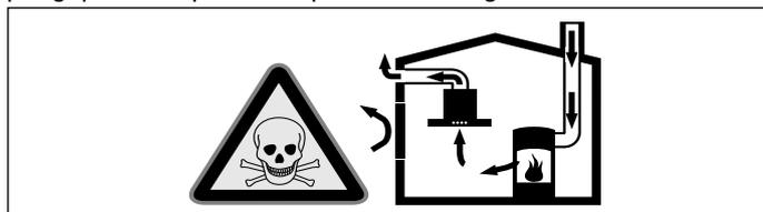
Peralatan pemanas ruangan (msl. pemanas berbahan bakar gas, minyak, kayu, atau arang, pemanas atau pemanas air berkelanjutan) mendapatkan udara pembakaran dari dalam ruangan di mana peralatan dipasang dan membuang gas sisa ke udara terbuka melalui sistem pembuangan gas (msl. cerobong asap).
