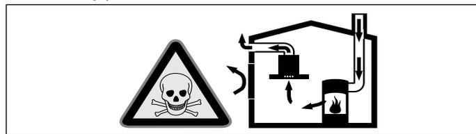
Ohniská závislé od vetrania miestnosti (napr. vyhrievacie prístroje na plyn, olej, drevo alebo uhlie, prietokové ohrievače, ohrievače vody) odoberajú dymové plyny z miestnosti, kde sú nainštalované a odvádzajú ich odsávacím zariadením (napr. komín) von.
