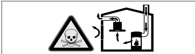
Uzavřené spotřebiče paliv (např. tepelné spotřebiče na plyn, olej, dřevo nebo uhlí, průtokové ohřívače, bojler) odebírají spalovací vzduch z místnosti, ve které jsou nainstalované, a spaliny odvádějí zařízením pro odvod spalin (např. komínem) ven.
