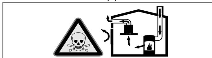
Eldstäder som är beroende av rumsluft (t.ex. värmeapparater som drivs med gas, olja, ved eller kol, genomströmningsapparater, varmvattenberedare) tar sin förbränningsluft ur det utrymme där enheten är installerad och leder ut avgaserna i det fria via en avgasanläggning (t.ex. skorsten).
